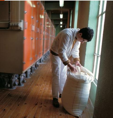
C. Parallèlement au travail des cylindres, les **plansichters** sont des appareils mécaniques qui permettent de tamiser les produits obtenus après chaque passage entre les cylindres. En fonction de leur taille, certains de ces produits sont orientés vers d'autres appareils à cylindres, et une partie de farine est extraite.
